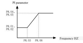
Fig. 5-8-1 PI parameters schematic diagram
