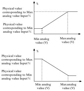
Fig. 5-4-1 Analog input linear curve
