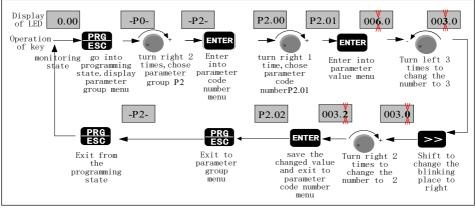
Fig. 3-5 Flow chart of parameter setting
